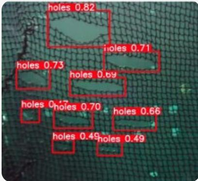
Identificación y Geolocalización de Defectos en Jaulas Marinas. Se han probado con éxito nuevos algoritmos basados en técnicas de IA (i.e. visión por computador y aprendizaje profundo) que permiten la detección de defectos, y su geolocalización, en las redes, a medida que se rastrea su superficie.
