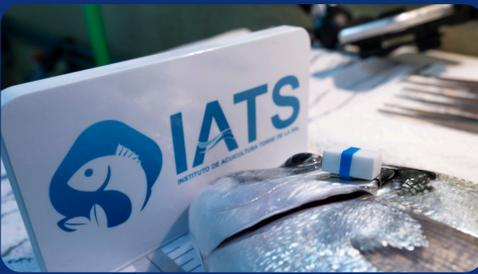
El nuevo prototipo de AEFishBIT (acelerómetro triaxial, anclaje en el opérculo) permite medir individualmente y con alta precisión los efectos del ambiente y de nuevas formulaciones de piensos sobre la cohesión social y la modificación del comportamiento en tests de estrés.
