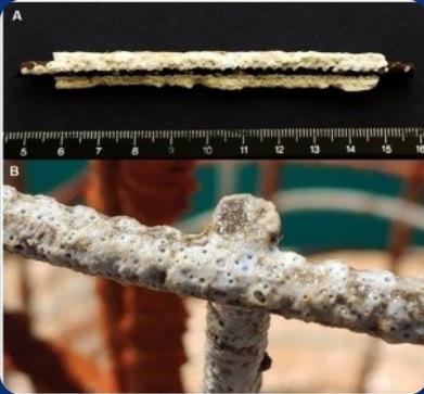
Se ha creado un recubrimiento calcáreo duro (calcita y aragonito) sobre mallazo de acero, fuertemente adherente y rugoso (favorecedor de la fijación larvaria) de espesor variable en función de la intensidad de la corriente continua (general, fotovoltaica). Ello ha dado lugar al modelo de utilidad: PT/ES2021/070734
